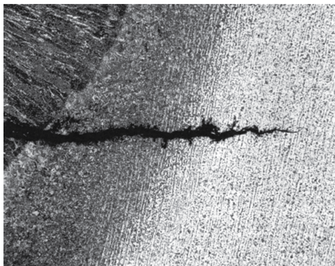
Figura 8. Trincamento SSC em aço A-516 resistente ao HIC (ver item 4). A trinca nucleada na ZTA propaga no metal base por um mecanismo associado ao SOHIC (10) 50×.
